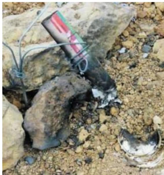
Fotografija 30- pirotehnika "fontana" za uklanjanje eksplozivnih sredstava
